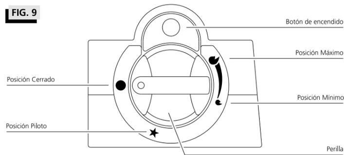
(\*). Este es el tiempo necesario para activar la válvula de seguridad incorporada en todos los calefactores ORBIS. Si por cualquier causa se apagase el calefactor, esta válvula corta totalmente el paso de gas, garantizando la máxima seguridad durante el uso.
