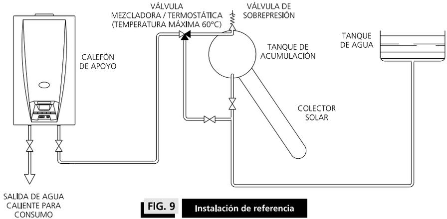
**IMPORTANTE:** Por seguridad del usuario, el agua que ingresa al artefacto no debe superar los 60°C. Por ello es necesario utilizar una válvula mezcladora termostática a la salida del equipo solar (ver figuras de instalación de referencia).
