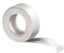
**Cinta Flex Corner:** Se utilizará como terminación de aristas formadas por planos que forman ángulos distintos a 90°. Se aplicará a la superficie de la placa con Masilla Durlock®, siguiendo los mismos pasos que para el tomado de juntas.
