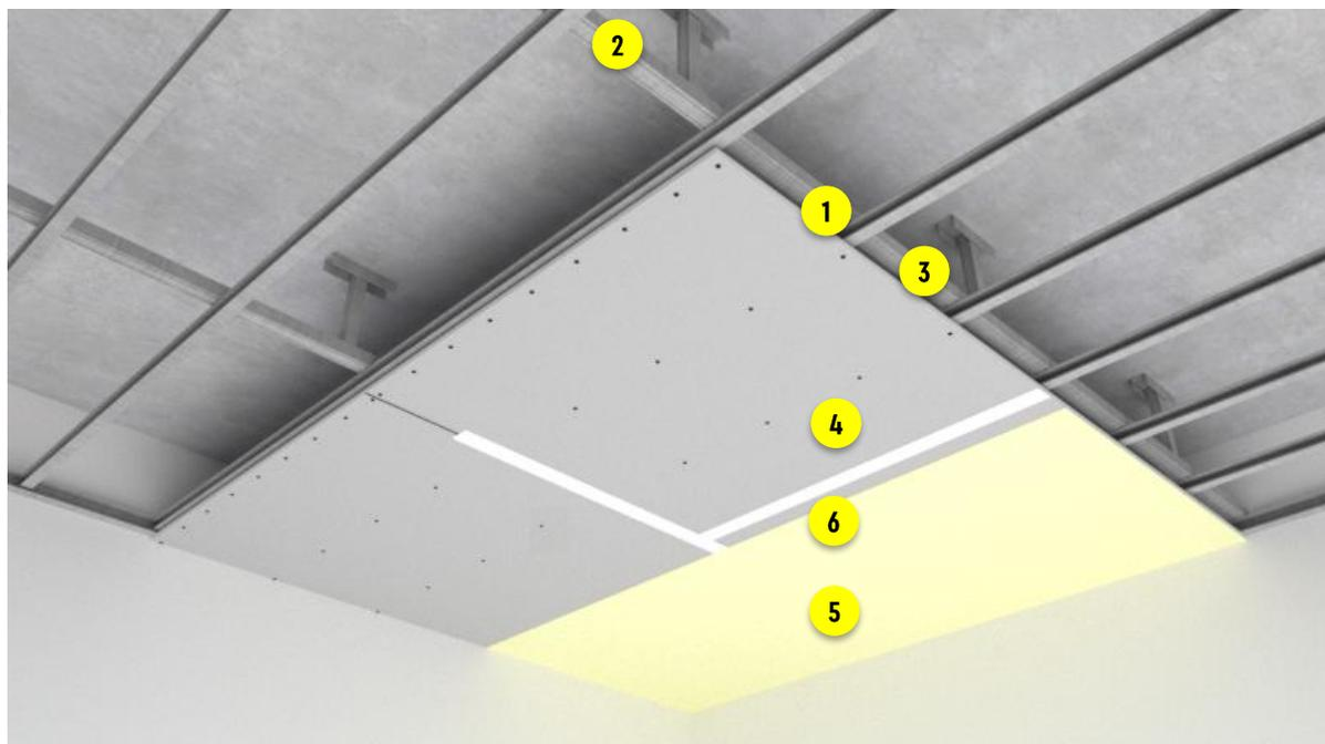
Cielorraso interior, compuesto por una estructura metálica de 35mm, a la cual se atornilla una capa de placas Durlock®.
